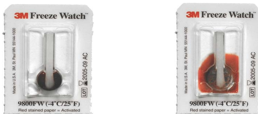
Kuva 2. Freeze Watch jäätymisindikaattori ennen jäätymistä (vas.) ja jäätyksen ( -4^{\circ}\text{C} ) jälkeen (oik.)
